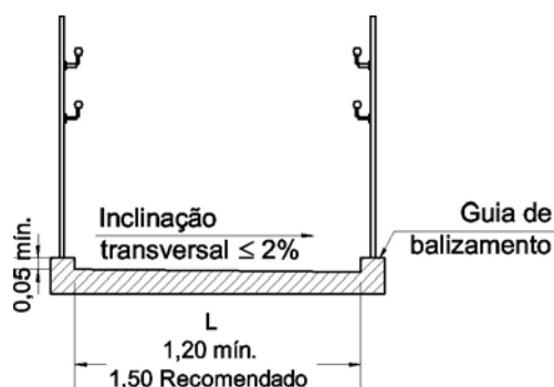
Figura 80 — Inclinação transversal e largura de rampas - Exemplo
