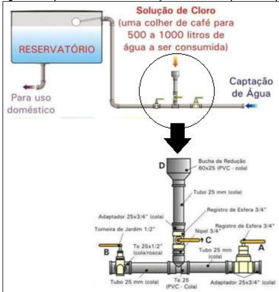
Figura 8 - Esquema do sistema de cloração desenvolvido pela Embrapa
