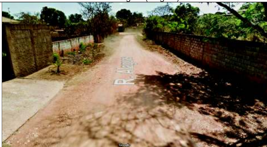
b – Exemplo de via não pavimentada sem estrutura de microdrenagem.
