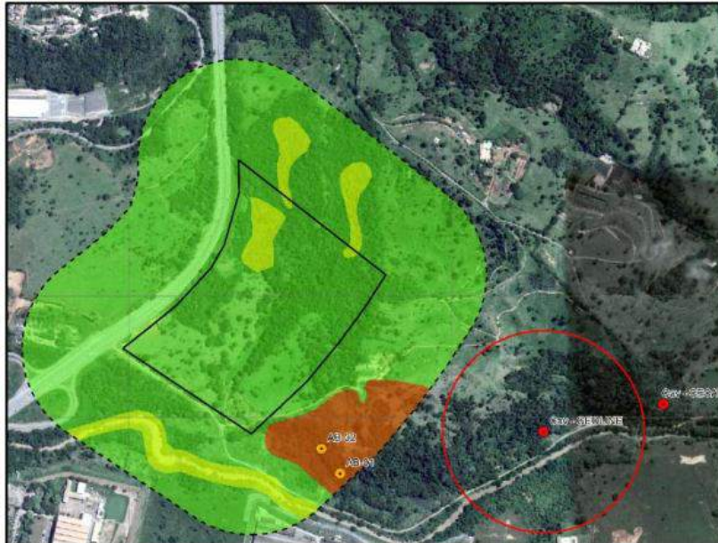
Figura 14 - Detalhe da localização da cavidade identificada na AID do empreendimento no estudo de prospecção espeleológica. Percebe-se que o raio de proteção máximo de 250 metros não está influenciando na ADA. Fonte: Geoline Engenharia, 2018.
